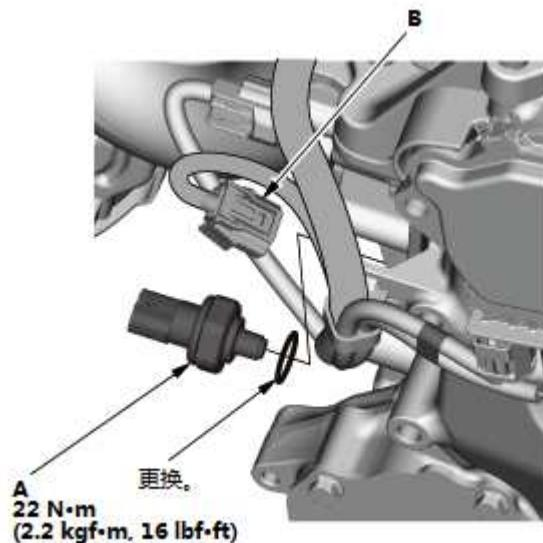
1. 在摇臂机油压力传感器螺纹上涂抹密封胶 (P/N 08C70-K0334M)。涂抹密封胶后 4 分钟内安装零部件。
